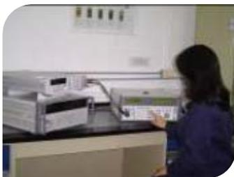
Calibrador Multifunciones, Fluke, 5520A; Bobina de 50 vueltas, Fluke, 5500A/Coil; Multímetro de 6 1/2 dígitos, HP, 34401A; Generador de funciones, HP, 33120A; Punta de prueba de alta tensión, Fluke, 80K40; Multímetro de 8 1/2 dígitos, Agilent, 3458A; Derivador de corriente continua,
